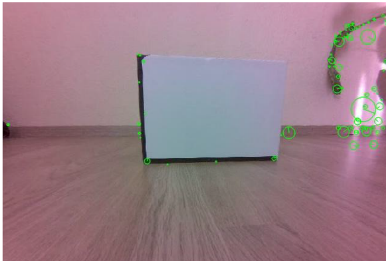
Abbildung 2-11: Feature-Erkennung mit dem SIFT-Algorithmus
