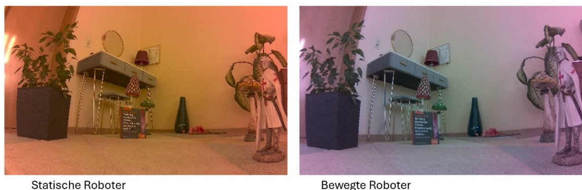
Abbildung 5-28: Unterschied in der Bildqualität zwischen einem statischen und einem bewegten Roboterzustand
