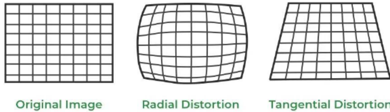
Abbildung 2-7: radiale- und Tangentiale Verzerrung [Geeksforgeeks, 2024]
