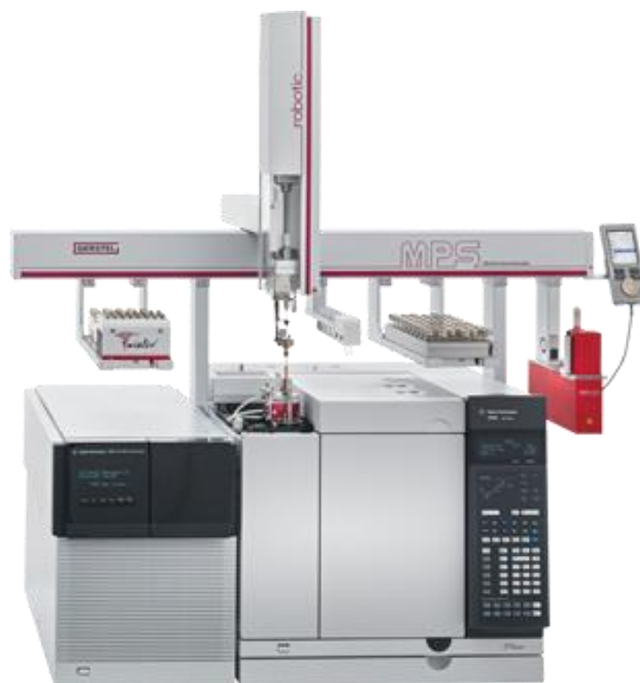
Abbildung 6: GC-MS/MS Gerät von Agilent Technologies GC 7890B + 7010 Triple Quad MS und Multifunktioneller Autosampler (MPS) von Gerstel [16]
