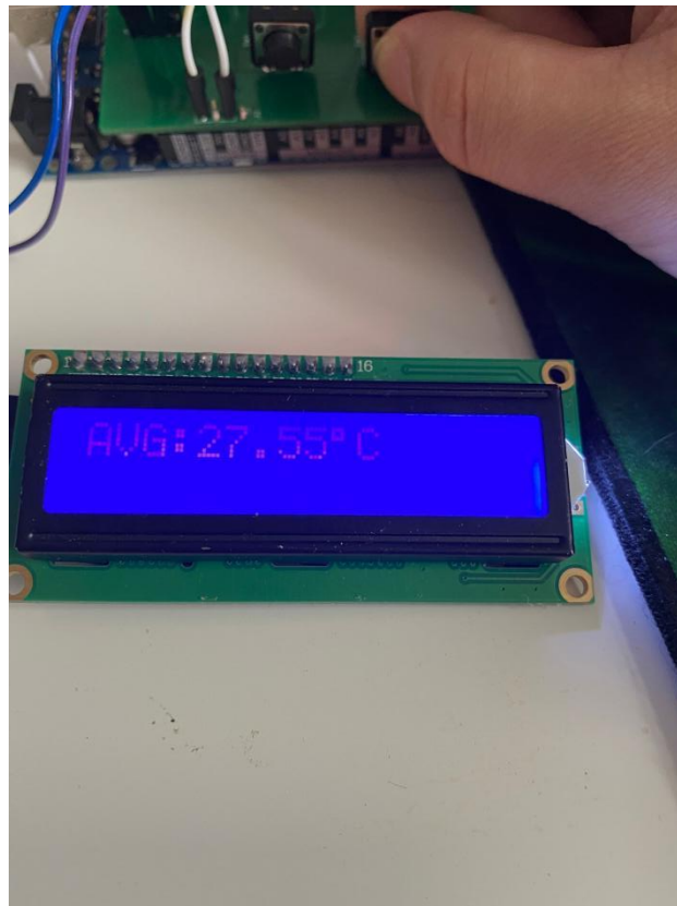
Abbildung 21: Anzeige von Durchschnittstemperatur
