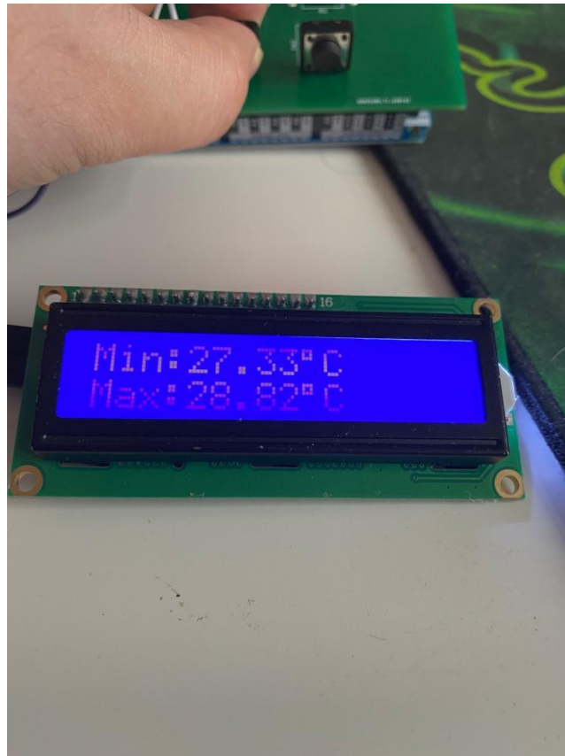
Abbildung 20: Anzeige von Maximal- und Minimaltemperatur
