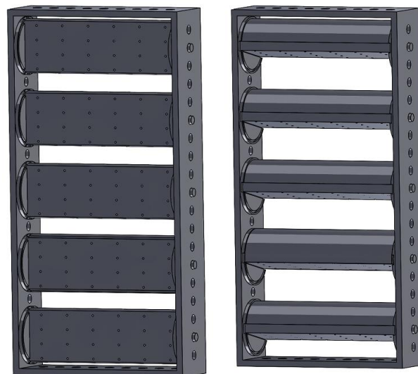
Abbildung 19 Solidworks-Simulation: Luftauslassgitter mit Lochblech und Rotationsfunktion
