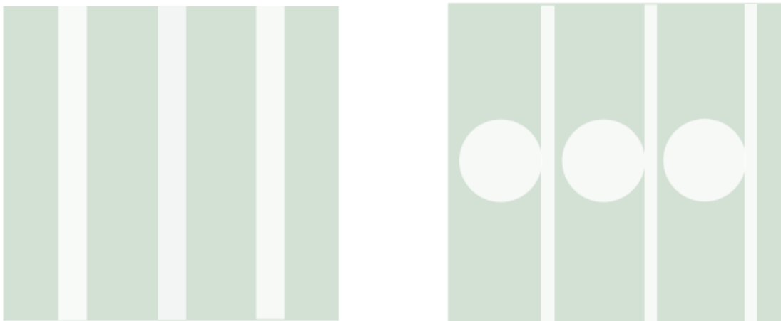
Abbildung 7 Modelle für poröse Stoffe mit gleicher Porosität und unterschiedlichem Strukturfaktor
