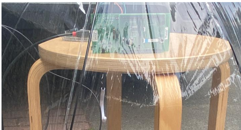
Abbildung 26 Abbildung eines mit PVC-Kunststoff bedeckten Sensors
