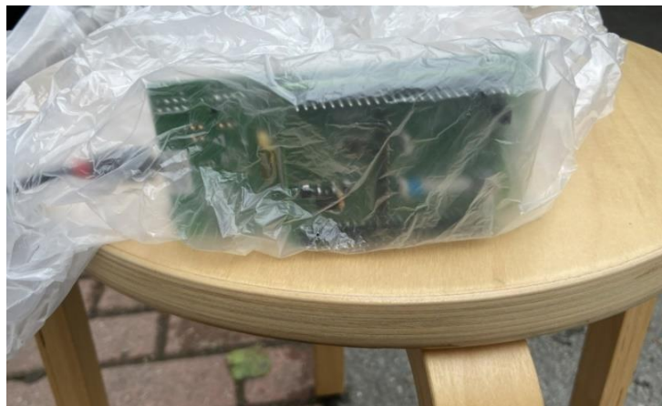
Abbildung 28 Abbildung eines mit PE-Kunststoff bedeckten Sensors
