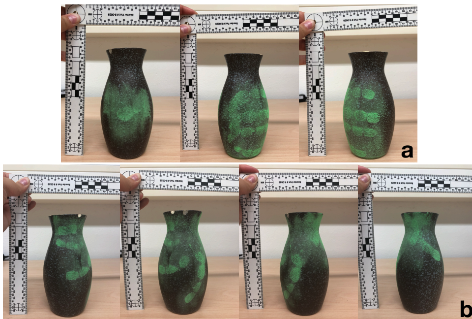
Abbildung 3.6: Sichtbarmachung der Fingerabdrücke an der Vase mit Floureszenzpulver. a erster Griff "Normal", b zweiter Griff "Schlag" (Eigene Darstellung)
