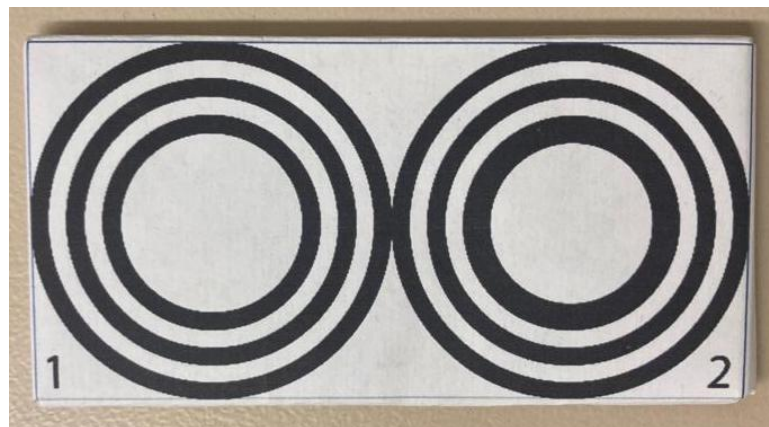
Abbildung 2.8: CC-Tag Typ 3 als Referenzmaß bei der Datenverarbeitung (Eigene Darstellung)
