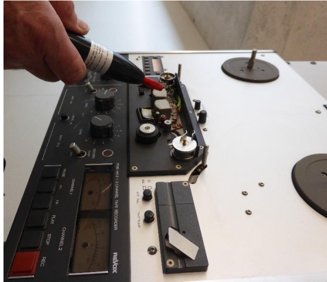
Abbildung 10 Entmagnetisierung des Bandlaufbereiches (eigene Aufnahme)
