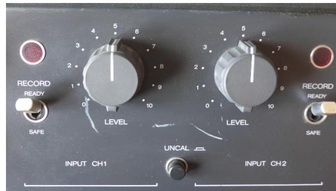
Abbildung 18 Aufnahmevorwahlschalter beider Kanäle auf READY (eigene Aufnahme)
