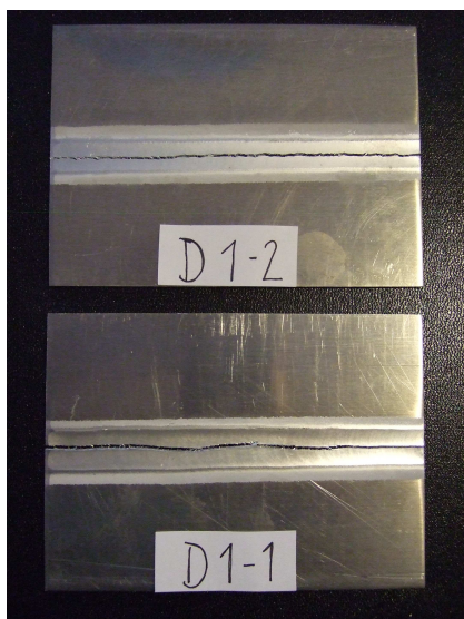
Abb. 27: Schweißproben D1 (AlSi1MgMn / T651)
