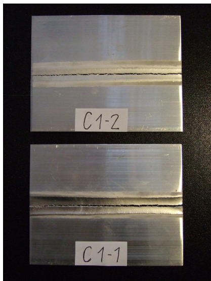
Abb. 25: Schweißproben C1 (AlMgSi / T66)
