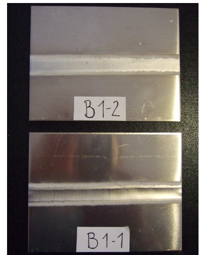
Abb. 24: Schweißproben B1 (AlMg3 / H111)
