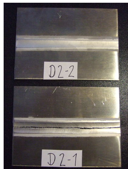
Abb. 28: Schweißproben D2 (AlSi1MgMn / T4)
