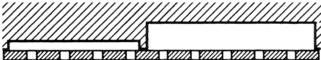
Abb 4.31 Phasengitter aus verschieden abgestimmten Lochplattenabsorbern
