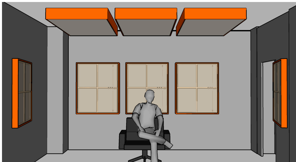
Abb 4.40 Anordnung der porösen Absorber im Raum
