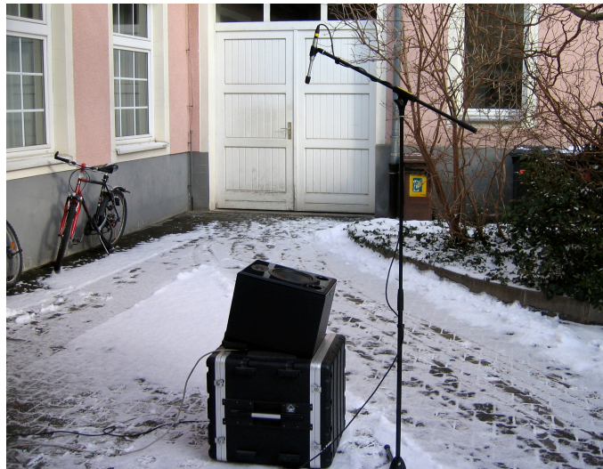
Abb 6.43 Messaufbau Freifeldmessung ASP8
