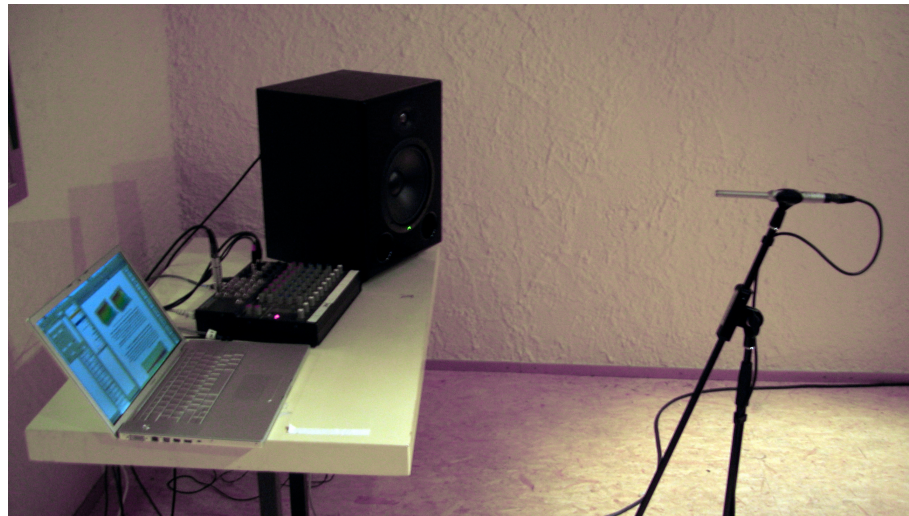
Abb 6.28 Messaufbau zur Messung ohne Akustikausbau
