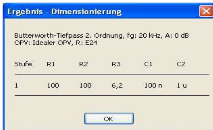
Bild 5.3.1 Dimensionierung des Butterworth-Filters
