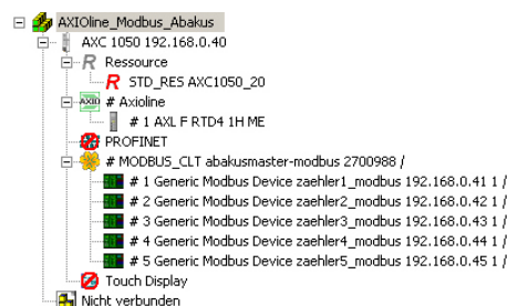
Abbildung 3.17: Axioline Modbus– homogener Aufbau
