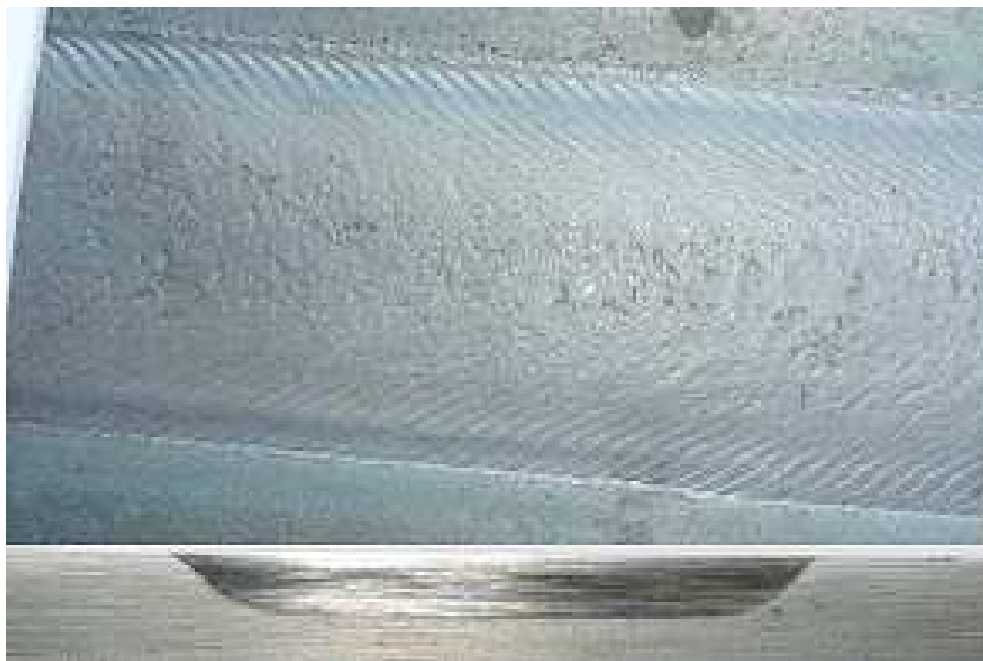
Abbildung 35: Legierung Fe-CrV15, Schweißnahtbewertung; Schliff, Ätzmittel: 5%ige alkohol. \text{HNO}_3
