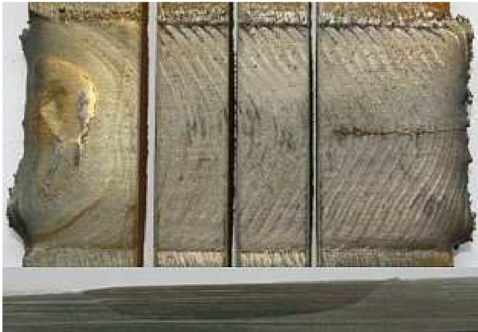
Abbildung 31: Legierung Fe-V12, Schweißnahtbewertung; Schliff, Ätzmittel: 5%ige alkohol. \text{HNO}_3
