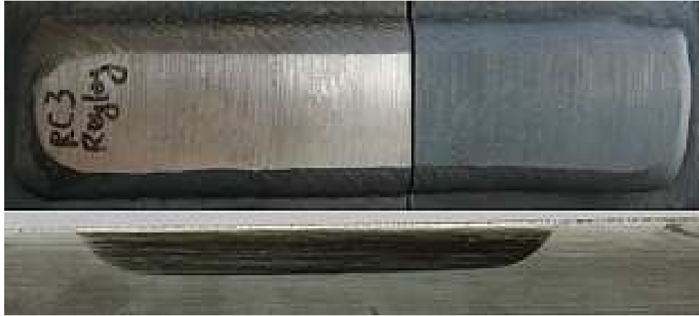
Abbildung 34: Legierung RC3, Schweißnahtbewertung; Schliff, Ätzmittel: 5%ige alkohol. \text{HNO}_3
