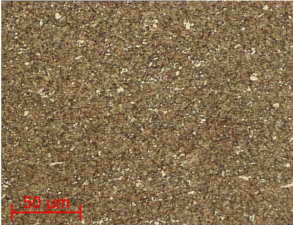
Abbildung 63: S6-5-2 angelassen; Gefüge mit Carbidverteilung; Ätzmittel: 5%ige alkohol. Salpetersäure
