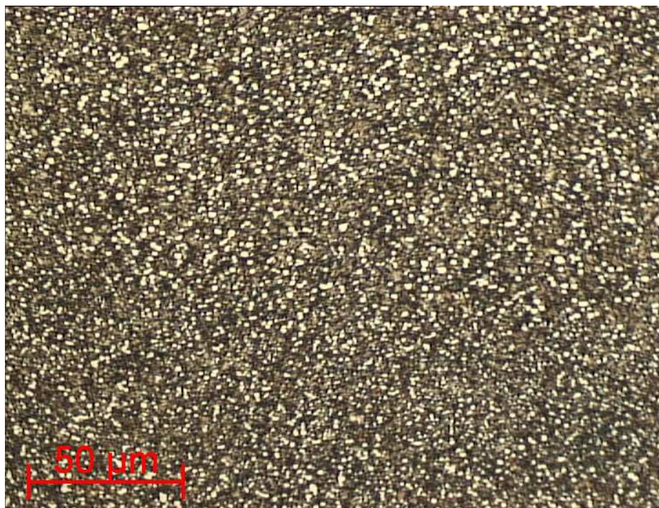
Abbildung 67: CPM 10V angelassen; Gefüge; Ätzmittel: 5%ige alkohol. Salpetersäure
