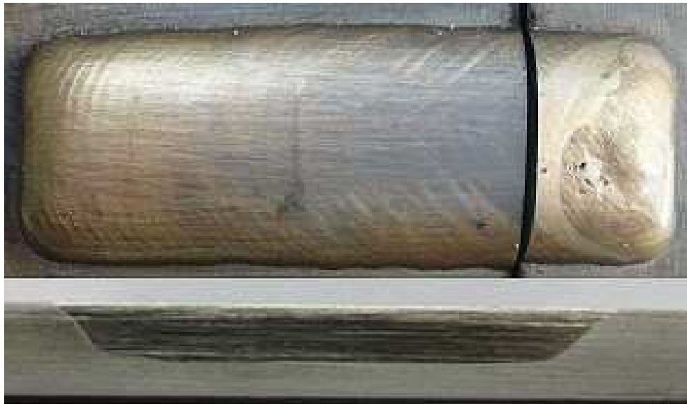
Abbildung 36: Legierung Fe-CrV15Mo20, Schweißnahtbewertung; Schliff, Ätzmittel: 5%ige alkohol. \text{HNO}_3
