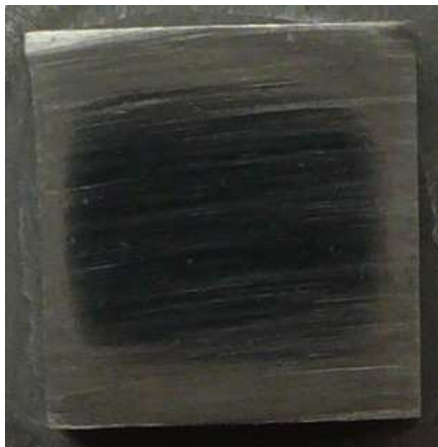
Abbildung 30: Schleifrippen; entstanden durch 180er SiC Schleifpapier im Schleifpapiertest bei einer Prüfzeit von 20 Sekunden
