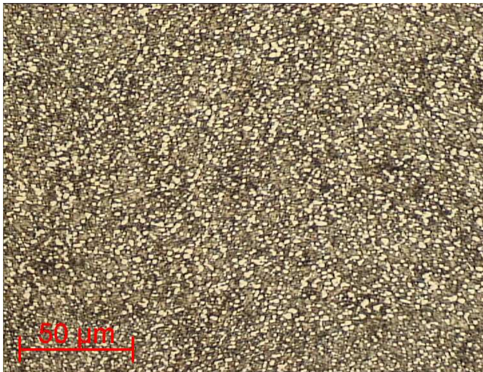
Abbildung 69: CPM 15V angelassen; Gefüge; Ätzmittel: 5%ige alkohol. Salpetersäure
