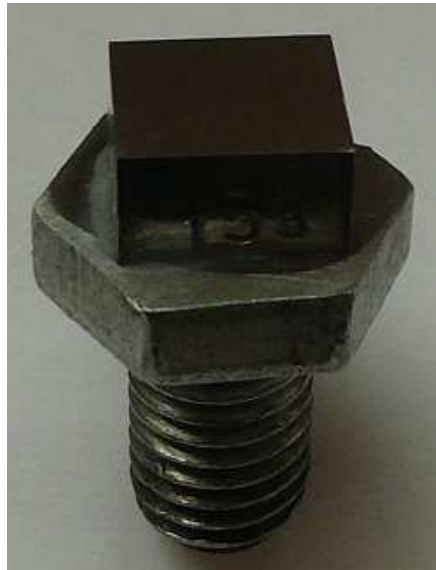
Abbildung 28: Probenhalter mit Prüfkörper
