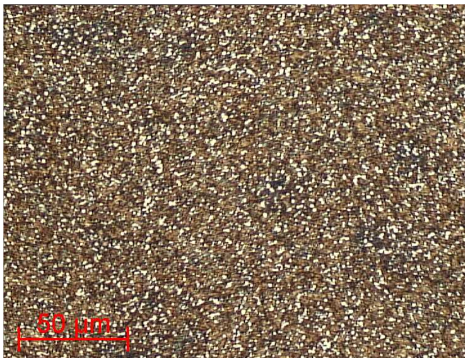
Abbildung 71: ASP 2023 angelassen; Gefüge; Ätzmittel: 5%ige alkohol. Salpetersäure
