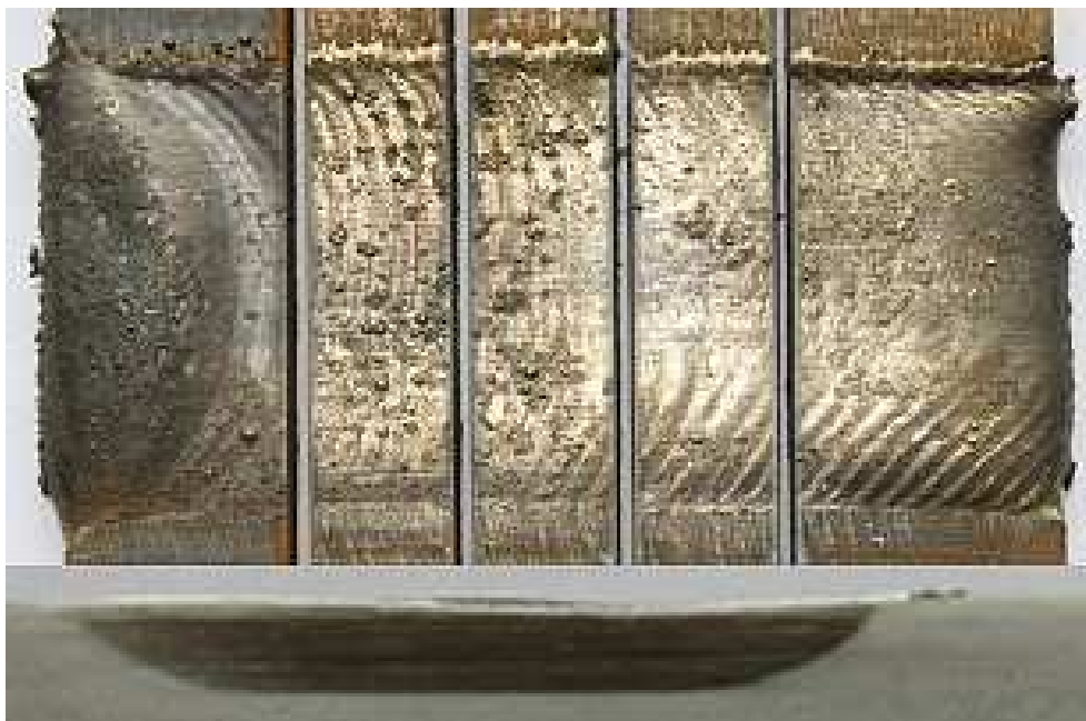
Abbildung 33: Legierung Fe-CrV15Mn15, Schweißnahtbewertung; Schliff, Ätzmittel: 5%ige alkohol. \text{HNO}_3
