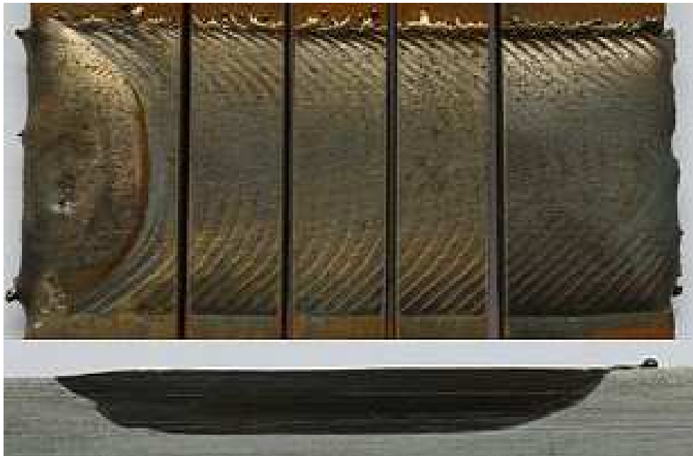
Abbildung 32: Legierung Fe-CrV15+6%Ni, Schweißnahtbewertung; Schliff, Ätzmittel: 5%ige alkohol. \text{HNO}_3
